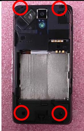
1. PRESS THE HOUSING AROUND TO FIX THE HOUSING.
